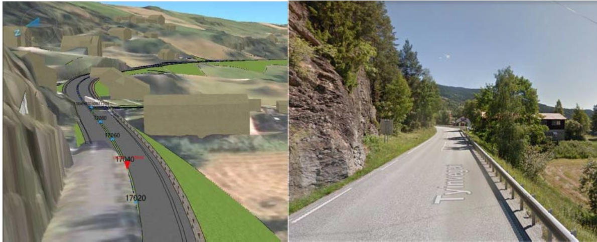
Eksempel fra Løkje hvor breddeutvidelse av E16 til 8,5m inkludert asfaltert skulder på 2 x 0,75m og utretting av kurver, vil medføre at E16 blir mindre uegnet for mjuke trafikanter.
