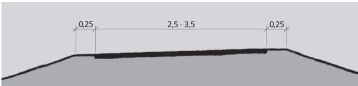
Figur 2 Normalprofil gang- og sykkelveg. Minimum 2,5 meters bredde på strekningen Holstad – Retvet. Kilde Hb N100 Veg- og gateutforming (Figur E.27)
