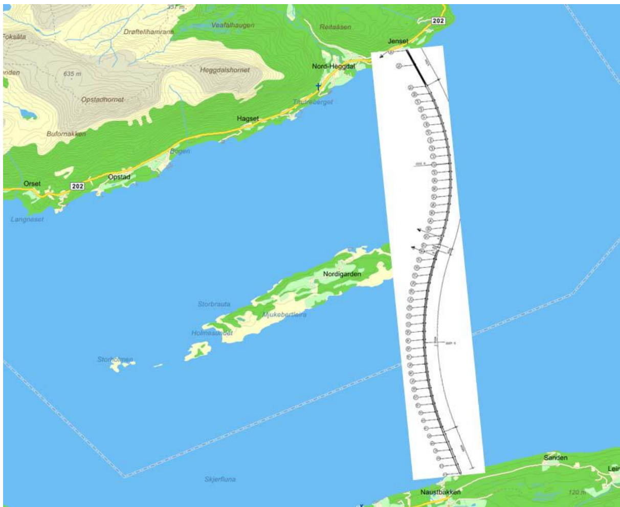
Figur 9 - Vurdert plassering og utforming av flytebru Vik-Tautra-Otrøya
