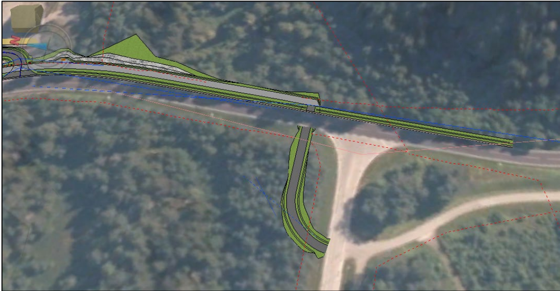
Figur 29 Utsnitt fra vegmodell viser byggetrinn 1 med kryssing av fv. 662 i plan. Tilrettelagt kryssing.
