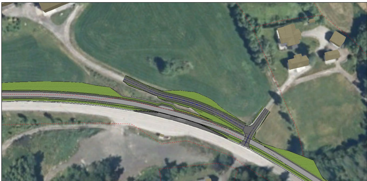
Figur 36 Avkjørsel og bussholdeplass ved Bjerkeli og Mordal. Avkjørsel og holdeplass flyttes for å få plass til gang- og sykkelveg. Natursteinmur settes opp mellom gang- og sykkelveg og adkomstveg for å minske inngrep i dyrket mark.
