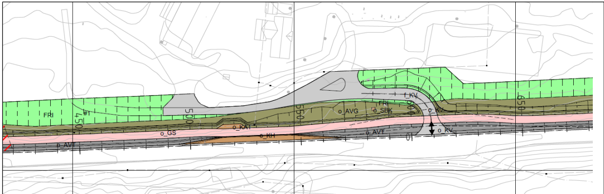
Figur 31 Avkjørsel ved barnehage og menighetshus er trukket 5 m fra vegkant på fv. 662.
