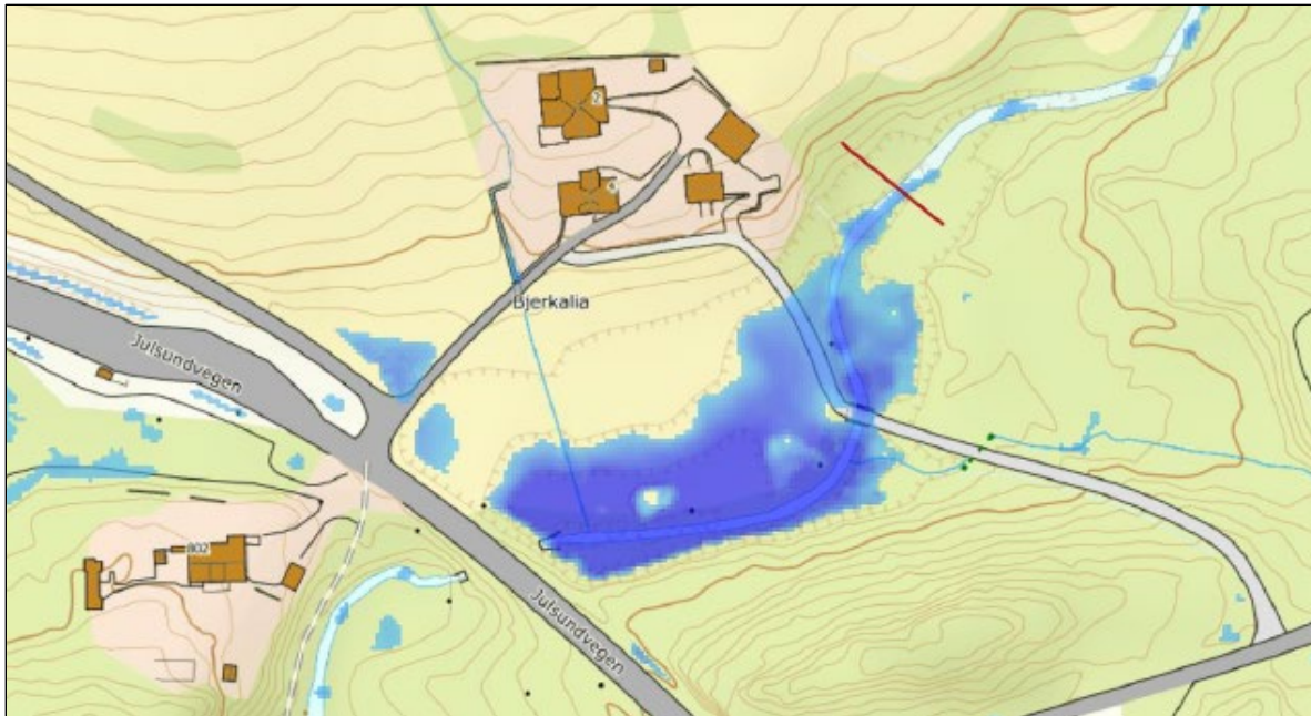
Figur 23 Viser en oppstuvning oppstrøms kulverten til kote 46,0 moh. Kartet er generert fra SCALGO LIVE. Kilde: SCALGO ApS, 2022.
