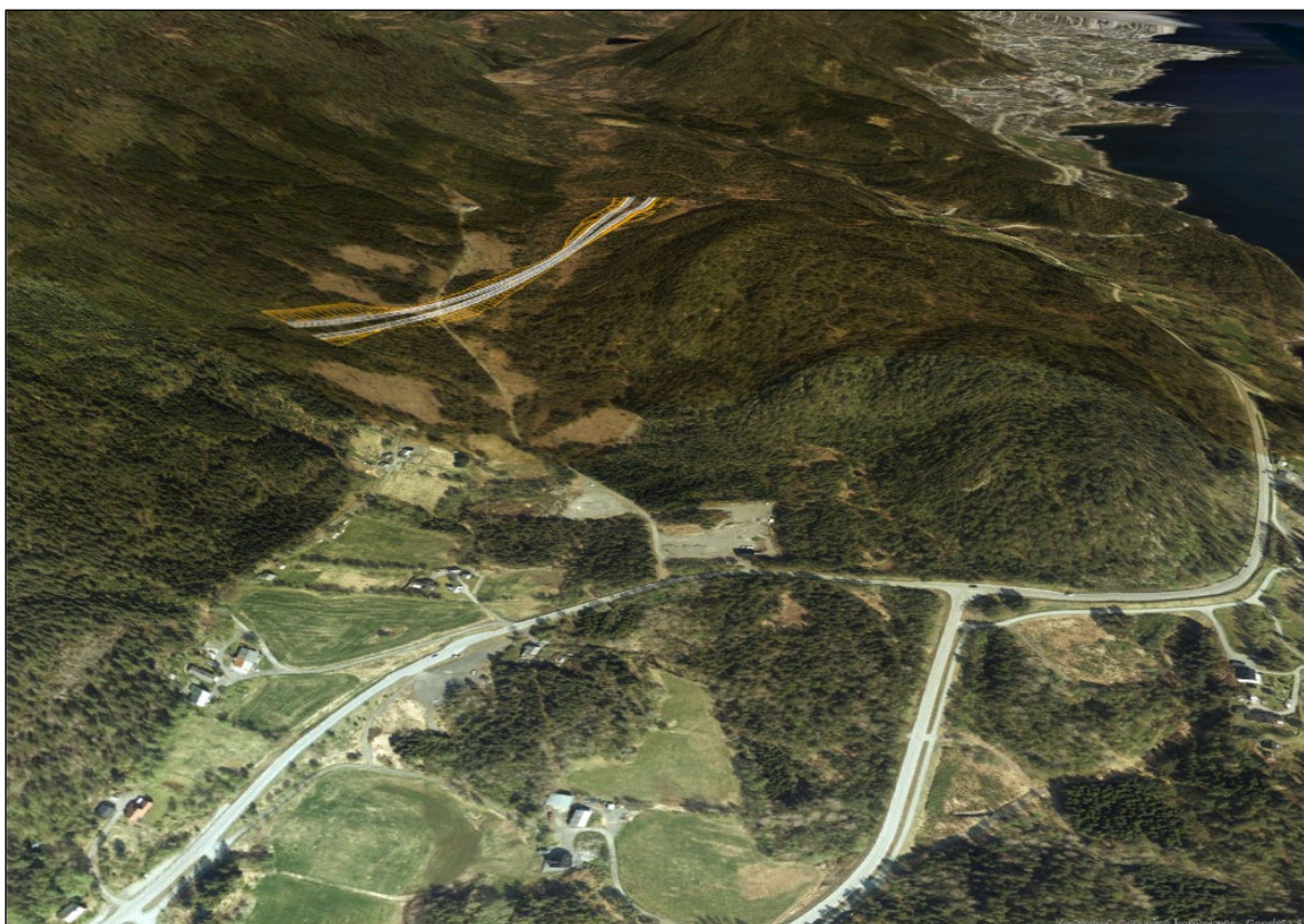
Figur 9 Fotomontasje som viser dagsone med 4 felt i Mordalen for Lilla veglinje. Bru er ikke vist, men vil komme der skogsbilvegen krysser veglinja. Haukabødalen ligger urørt.
