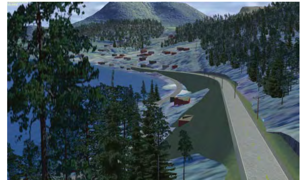
Fig 26, Illustrasjon viser fyllingsutslaget i møte mellom ny og gamal veglinje rett før Klokkargarden.
