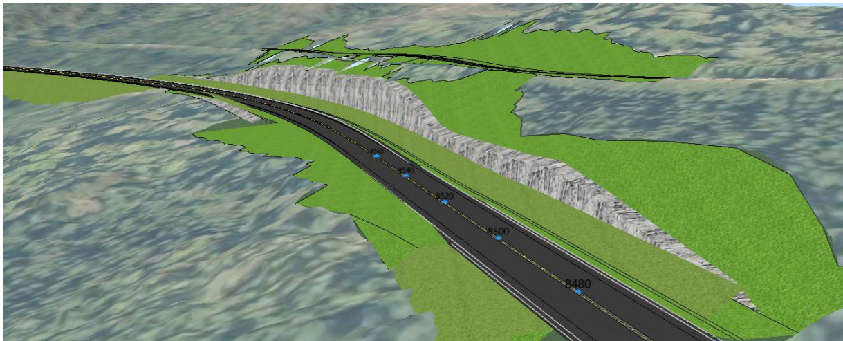
Figur 18 Utsnitt fra vegmodellen fra profil 8530 viser fjellskjæringa i sør (til høyre på bildet).
