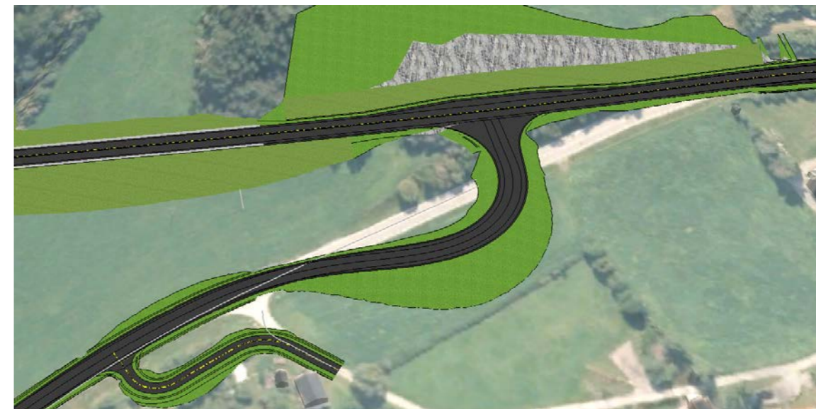
Figur 32 Viser hvordan nytt kryss E39/ fv. 354 Leirvika er tenkt utforma med passeringslomme på E39
