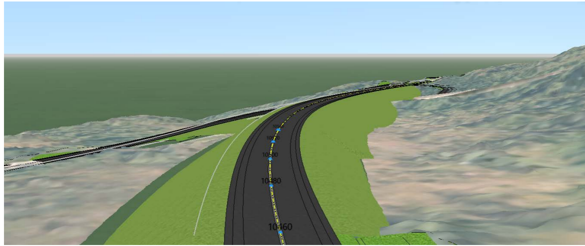
Figur 26 Utsnitt fra vegmodellen. Viser fra profil 10460, ei stor tosidig fylling som blir som en barriere i terrenget.
