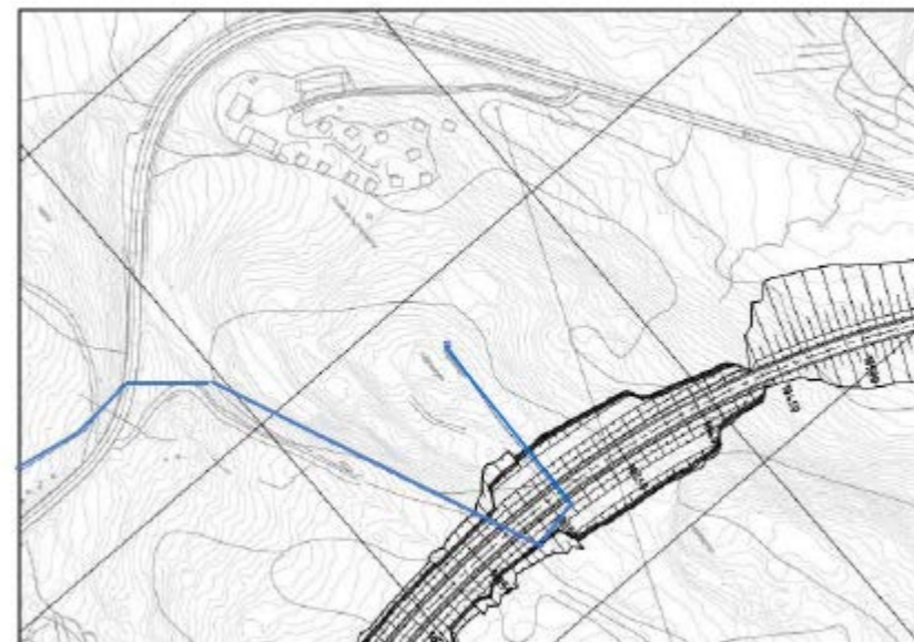
Figur 14 Kryssingspunkt for vassledning (blått strek) ved Oddhaugen.
