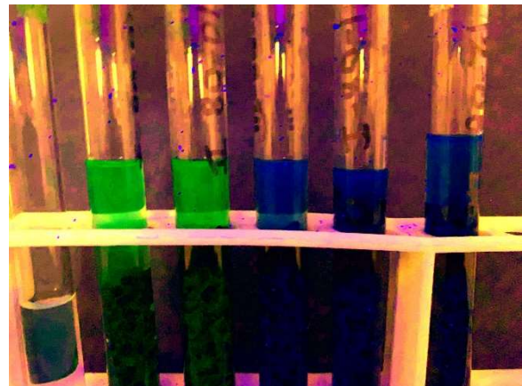
Figur 5b. Ekstraksjon av fluorescein fra de samme lokalitetene. Blank til venstre. Positivt signal (grønn fluorescens) i hovedkilda etter ett døgn, resten negativt. Resultater i samsvar med figur 5a. Det er altså direkte forbindelse fra elvebunnen til hovedkilda.
