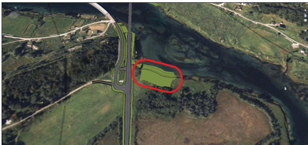
Fig 6-4: Ortofotogram som viser motfyllinger/stabiliseringstiltak med lys grønn farge. Tiltak er i konflikt med nordlige del av Evjen krigsfangeleir.
