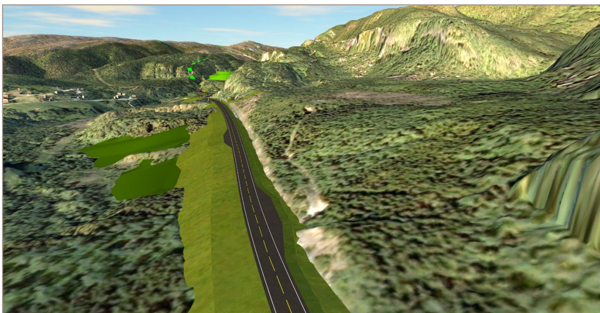
Figur 5-9 Eksempel på inngrep som følge av utslaking av fyllinger (lys grønt) og motfyllinger (mørk grønt) mellom Gyltvik av Kvarv. Bilde fra vegmodell.
