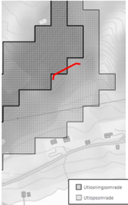
Figur 16: Viser løsne og utløpsområde for steinskred/sprang for søndre tunnelpåhugg Megården. (Kilde: rapport «50821-GEOL-05 Skredfarevurdering og vurdering av sikringstiltak»).
