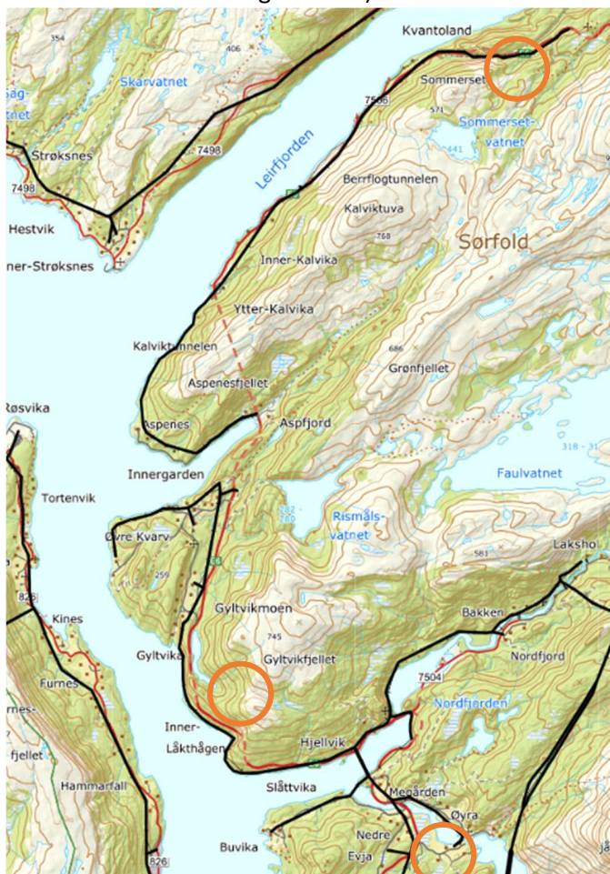
Figur 22: Viser kraftlinjer (Indre Salten Energi) langs eksisterende E6. Ny veg vil gi mindre nærføring til kraftlinjene. Oransje ring indikerer steder med høy nærføring og/eller kryssning mellom veg og kraftlinje. (Kilde: www.kart.dsb.no ).
