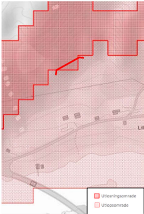
Figur 13: Utsnitt søndre påhugg til Megardskolltunnel, som ligger innenfor løsne- og utløpsområde for snøskred. (Kilde: rapport «50821-GEOL-05 Skredfarevurdering og vurdering av sikringstiltak»).
