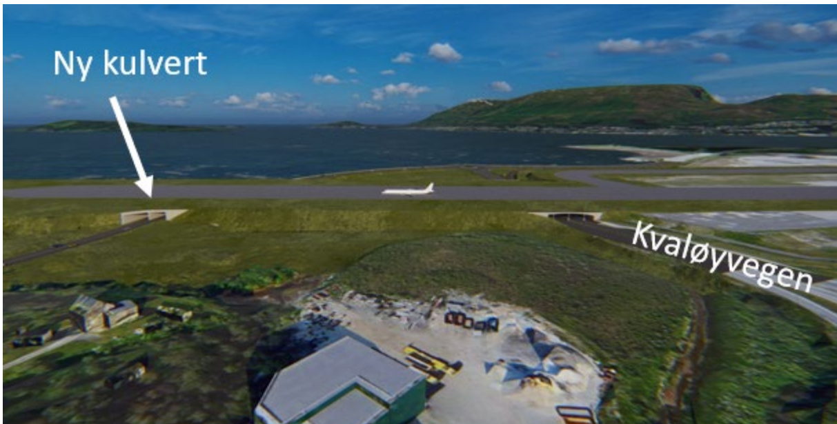
Figur 26 Illustrasjon med to kulverter
