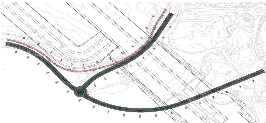
Figur 25: Plantegningen viser trasé der dagens kulvert for både kjøreveg og GS-veg tas i bruk, og vegnett tilpasses rundkjøring lokalisert på Giæverneset.
