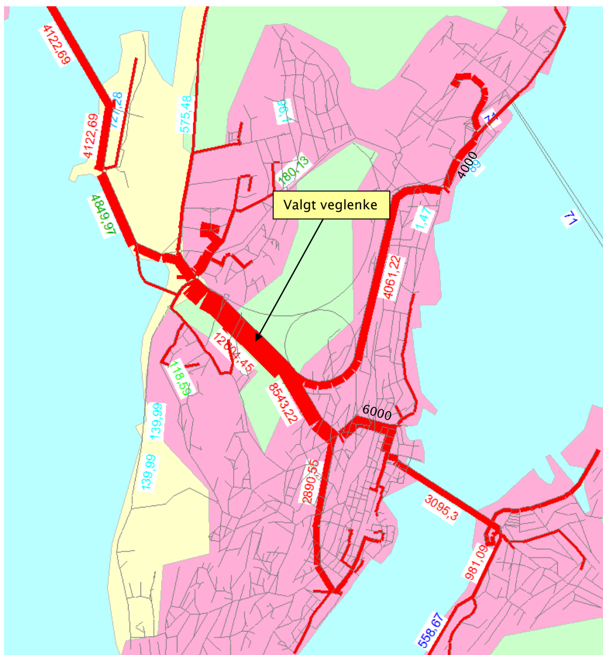
Figur 26 Viser hvor trafikken på «Valgt veglenke», kommer fra og hvor den skal til.
