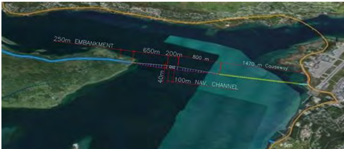
Broløsning som til sammen er 1750 meter. Fylling på ca 1470 meter
