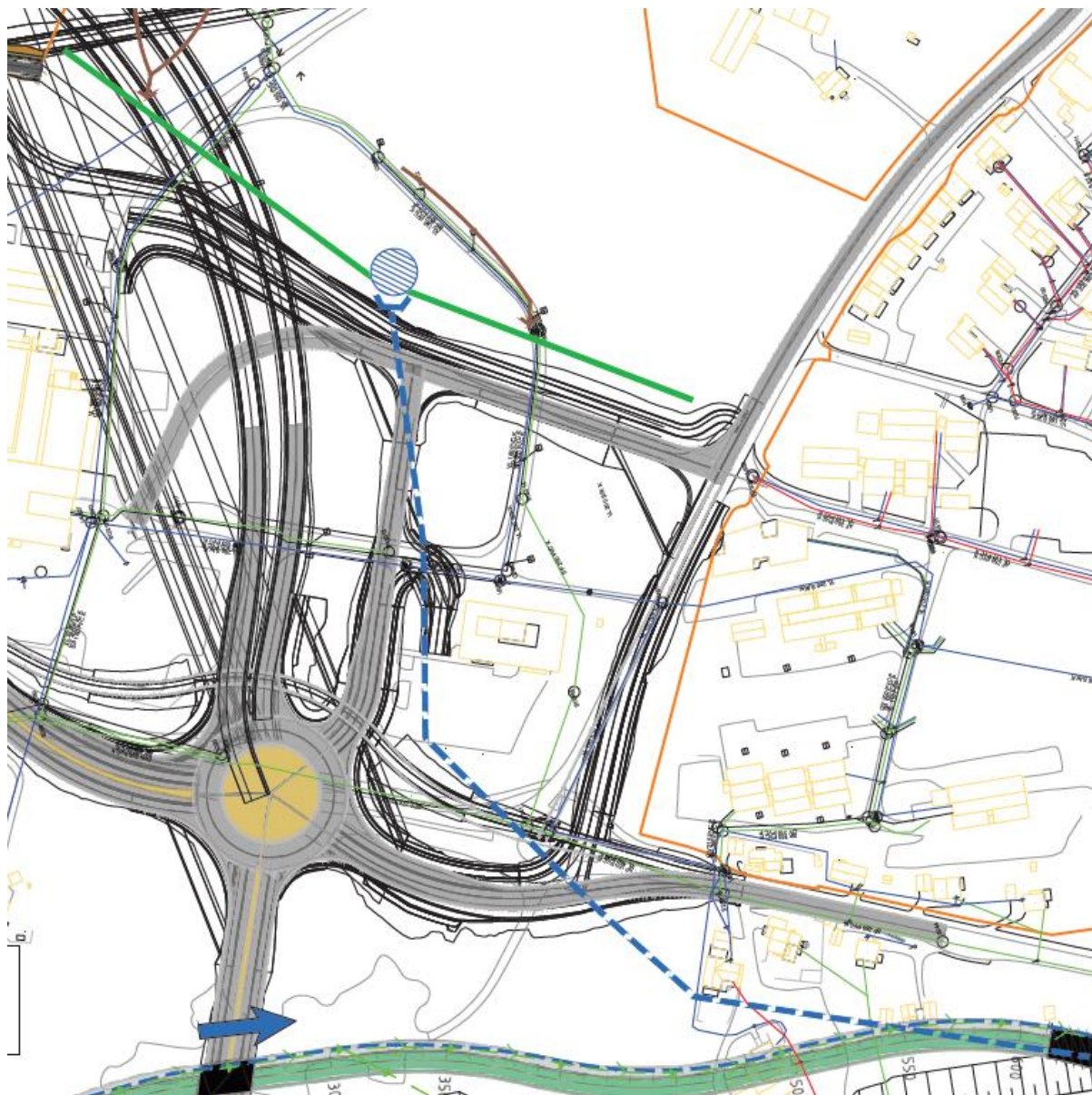
Fig 4.4 Prinsippløsning avskjæring av delfelt G01 og G02.
