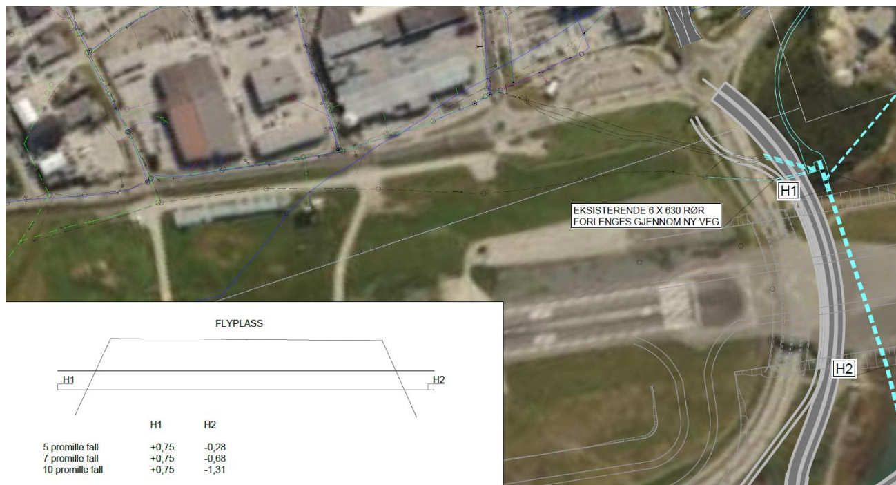
Fig 4.8 Plantegning av overvannspumpestasjon og første del av kulvert gjennom flyplassen
