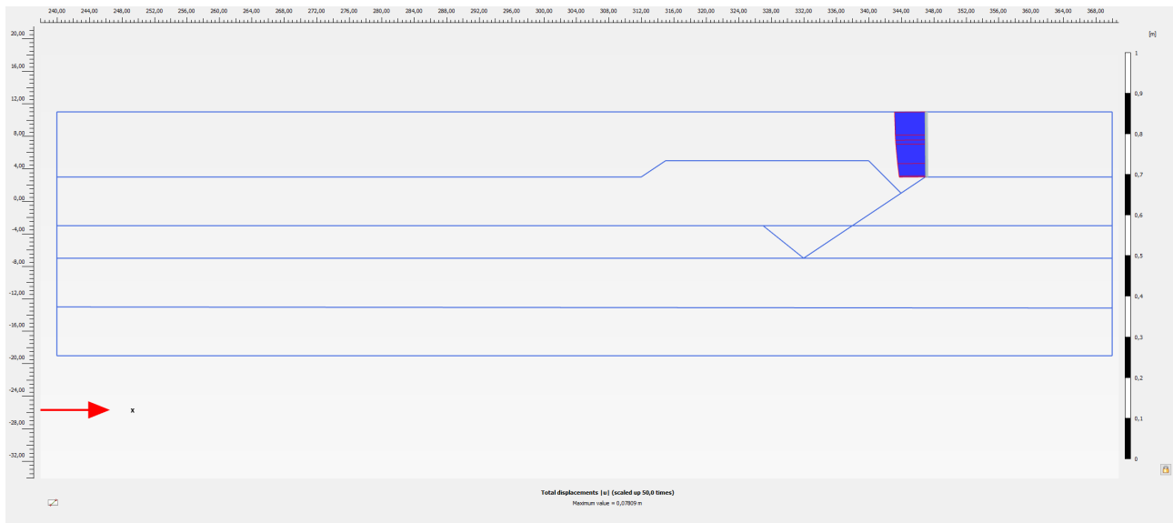
Figur 18- Utklipp fra Plaxis 2D som viser 7,8 cm total deformasjon ved kulvertvegg, ved oppfylling fra forbelastning til kote +11, uten leire under rullebaneforlengelsen. Dette er en referanse som viser hvilket bidrag setningen i leira utgjør for deformasjon ved kulvertvegg.
