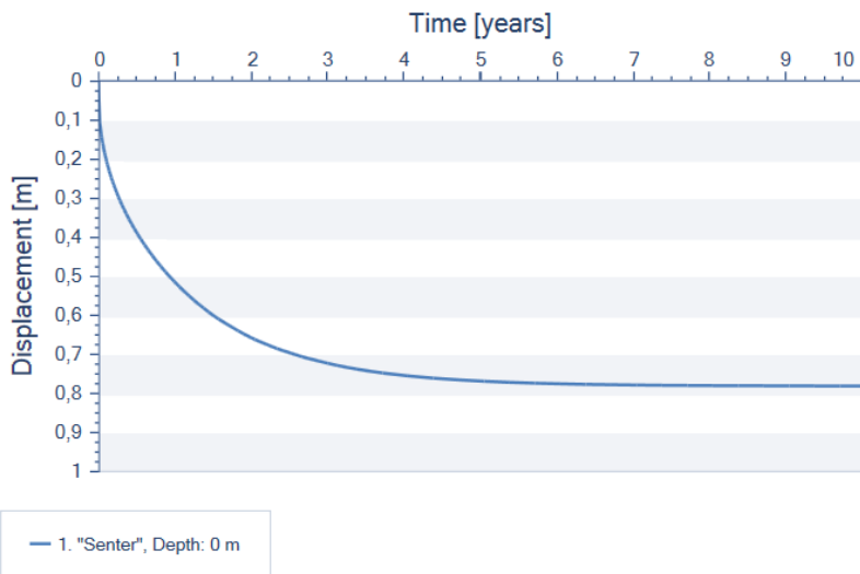
Figur 2 - 8m leire, sprengtstein til kote +11
