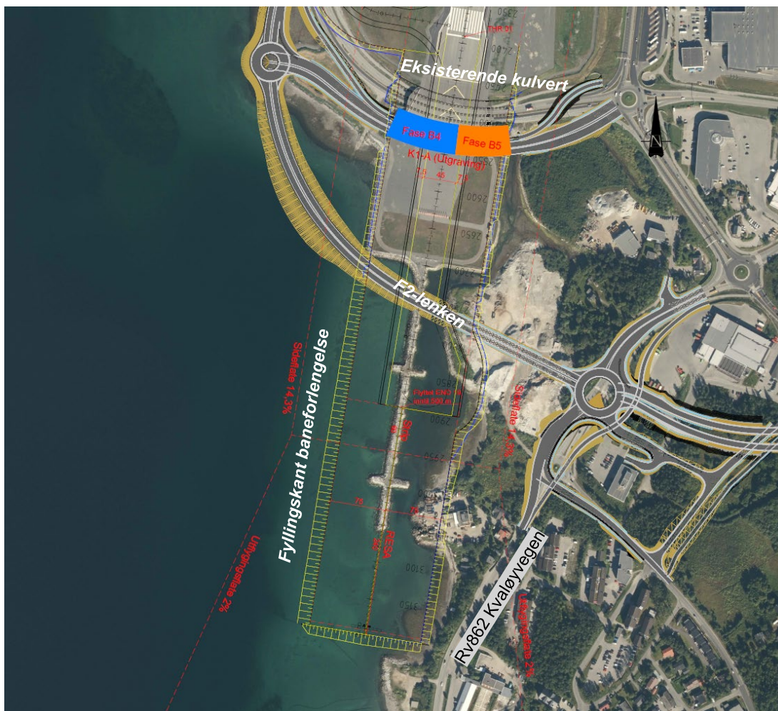
Figur 1 - Plantegning/Faseplan av rullebaneforlengelse og vegutbygging
