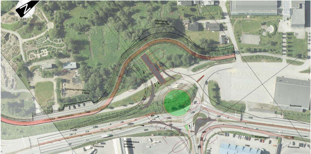
Figur 7: Prinsipp tegning for 5-armet rundkjøring.
