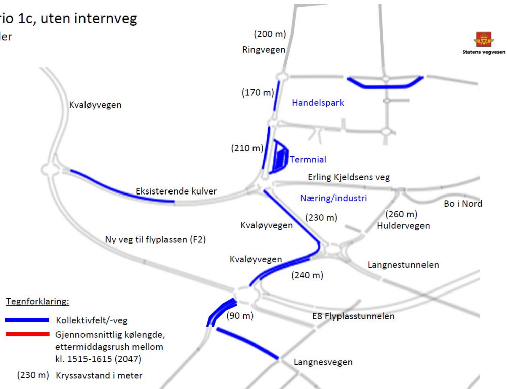
Figur 44: Illustrasjon av gjennomsnittlige kølgengder (røde streker) for scenario 1c (ingen kølgengder av betydning for 1c).
