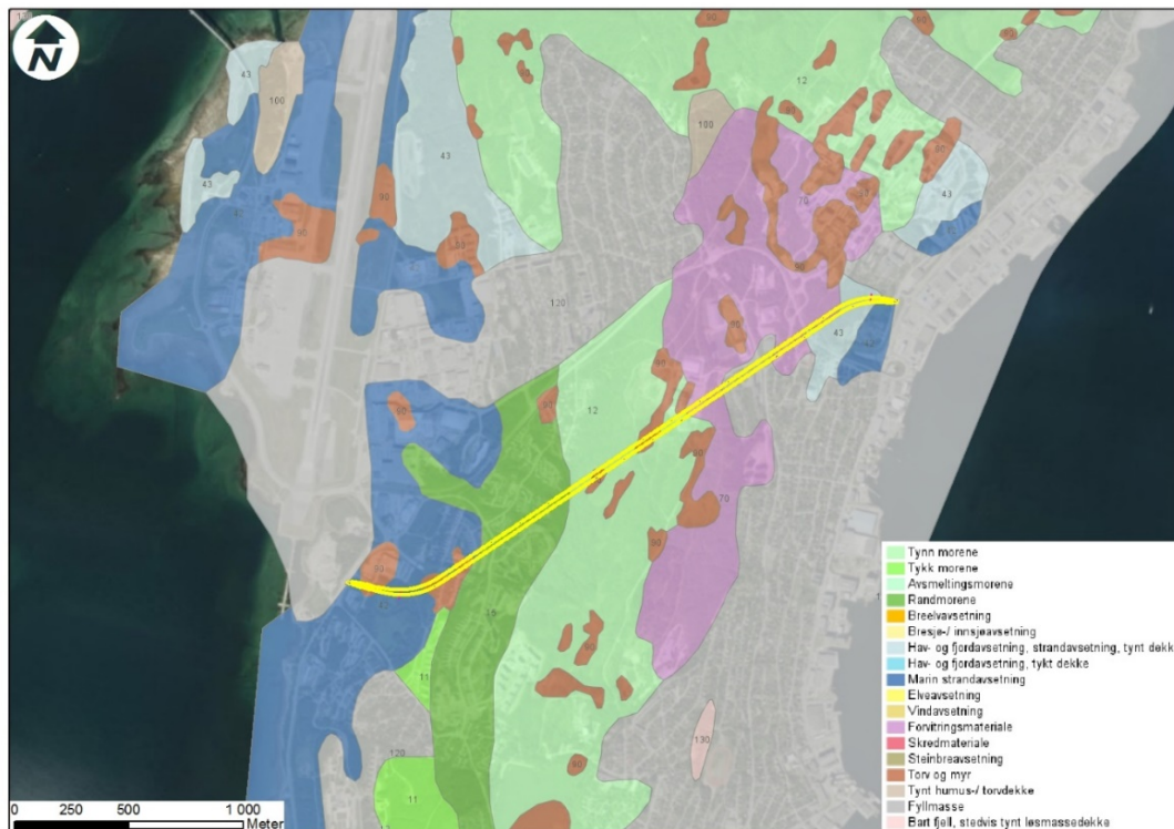
FIGUR 7 LØSMASSEKART OVER TROMSØYA FRA NGU. NY TUNNEL ER MARKERT I GULT CA. MIDT PÅ TEGNINGEN.
