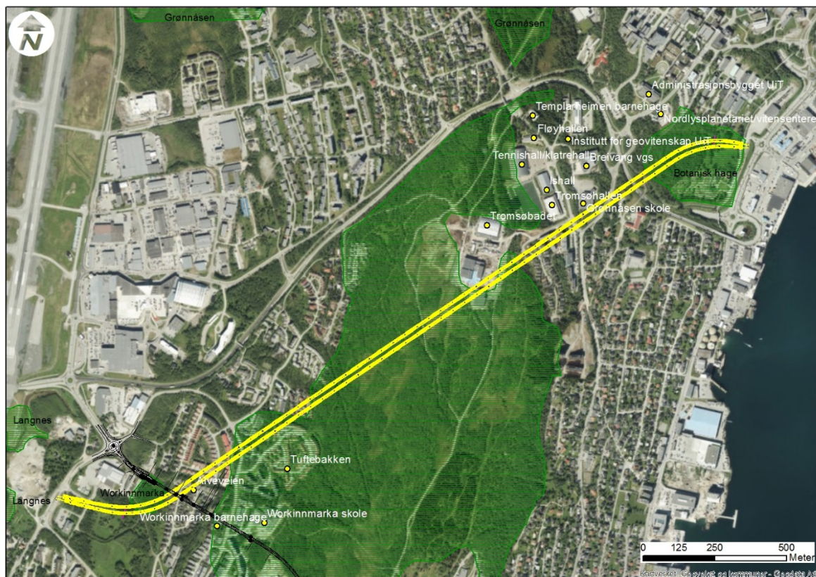
FIGUR 3 GRØNN POLYGON VISER NATURTYPER HENTET FRA MILJØDIREKTORATETS NATURBASE.NO. NAVNENE HENVISER TIL KARTLAGTE BYGNINGER HVOR DET ER INNHEMTET INFORMASJON OM FUNDAMENTERINGS- OG GRUNNFORHOLD.
