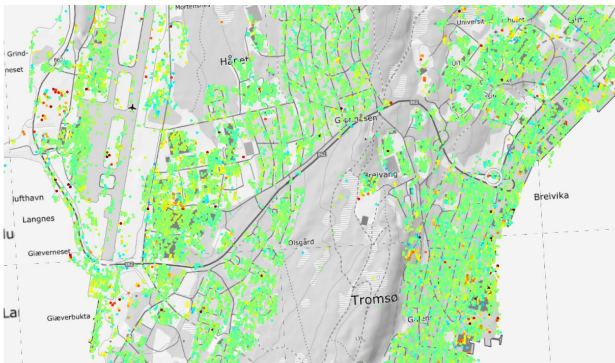
FIGUR 8 IN SAR-MÅLINGER FRA OMRÅDET DER NY TUNNEL VIL GÅ. GRØNNE PUNKER MARKERER OMRÅDER SOM STÅR I RO, BLÅ PUNKTER INDIKERER EN HEVNING, MENS GULE, ORANSJE OG RØDE PUNKTER INDIKERER OMRÅDER MED SETNINGER.
