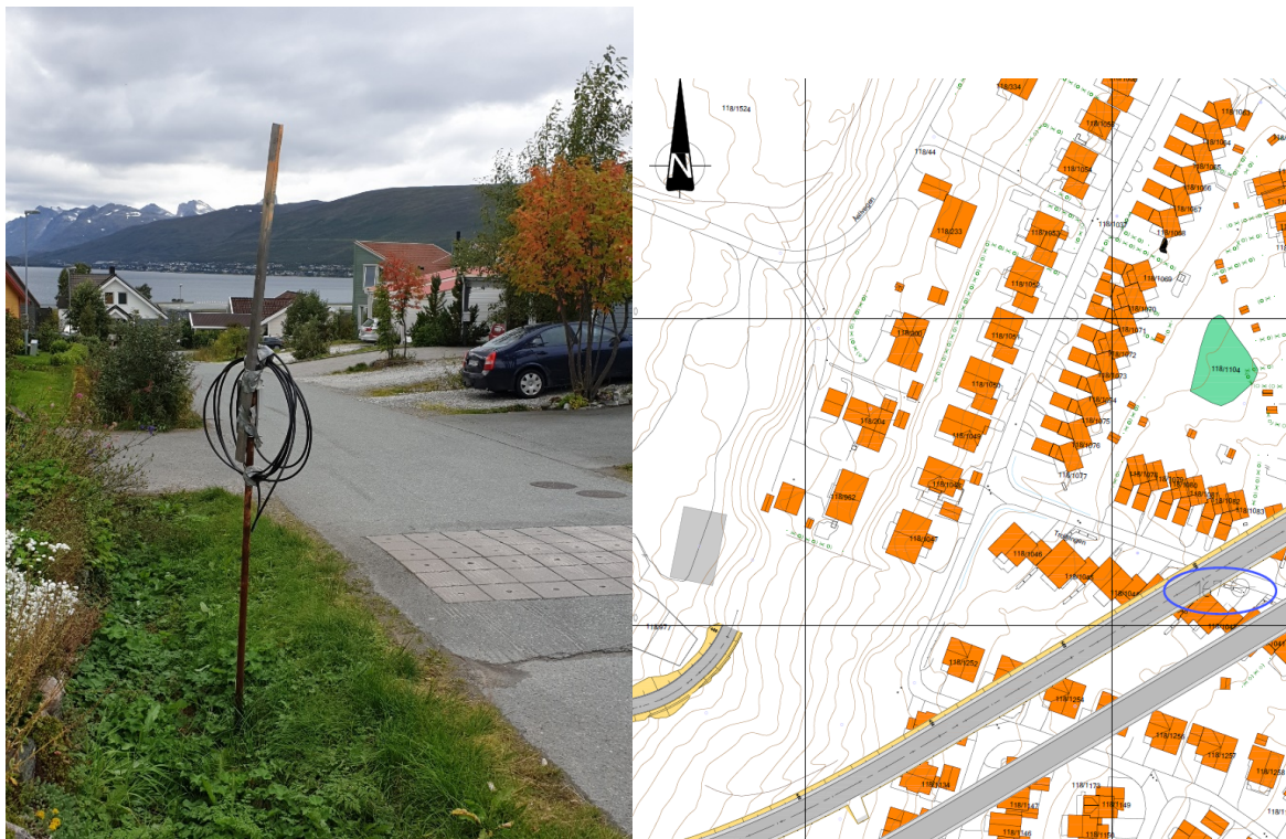
FIGUR 17 EN PORETRYKSMÅLER ER Plassert I TROLLRINGEN OVER TUNNELENE LIKE ETTER AT NY TUNNEL HAR KRYSETT DAGENS LANGNESTUNNEL.
