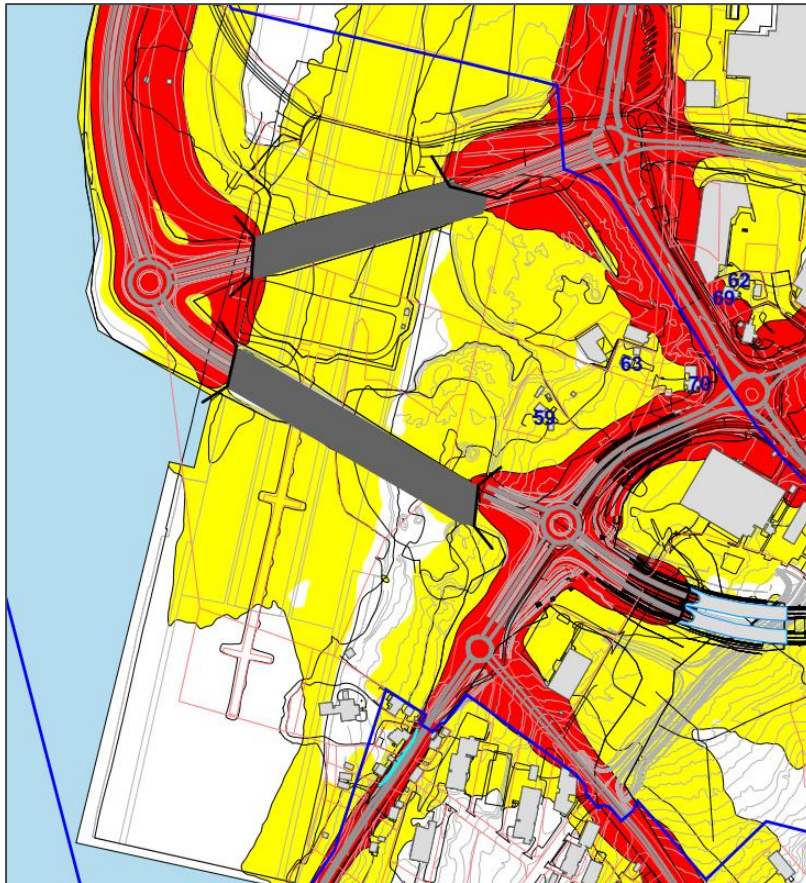
FIGUR 18 Støyberegninger for utsatte boliger på Langnes, fremtidig situasjon med utbygging.
