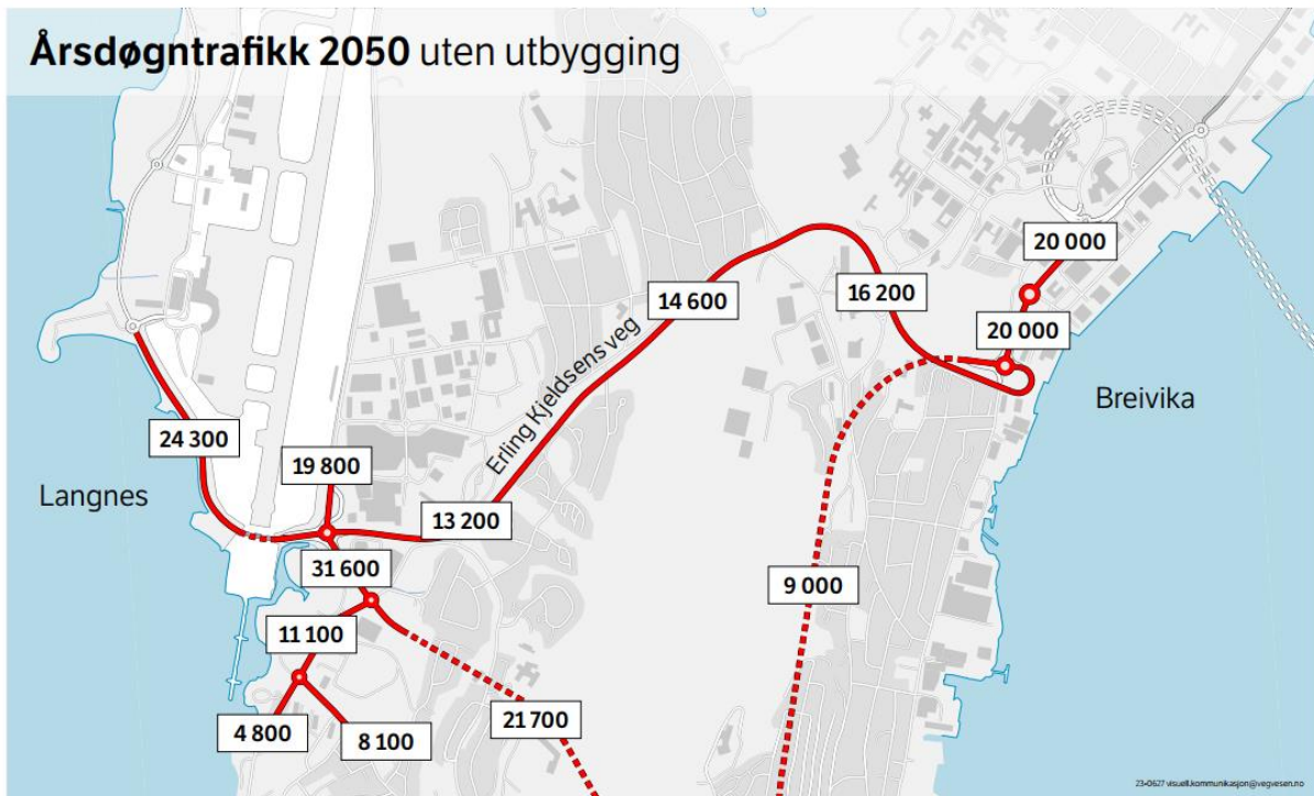
FIGUR 7 Trafikkforutsetninger for Breivika og Langnes i fremtidig situasjon uten utbygging av E8 flyplasstunnelen.
