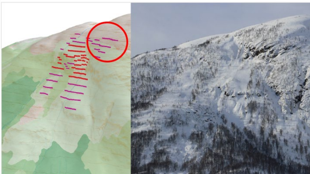
Figur 5: Illustrasjon som viser støtteforebygningene, der det sekundære løsneområdet er markert med rød ring.
