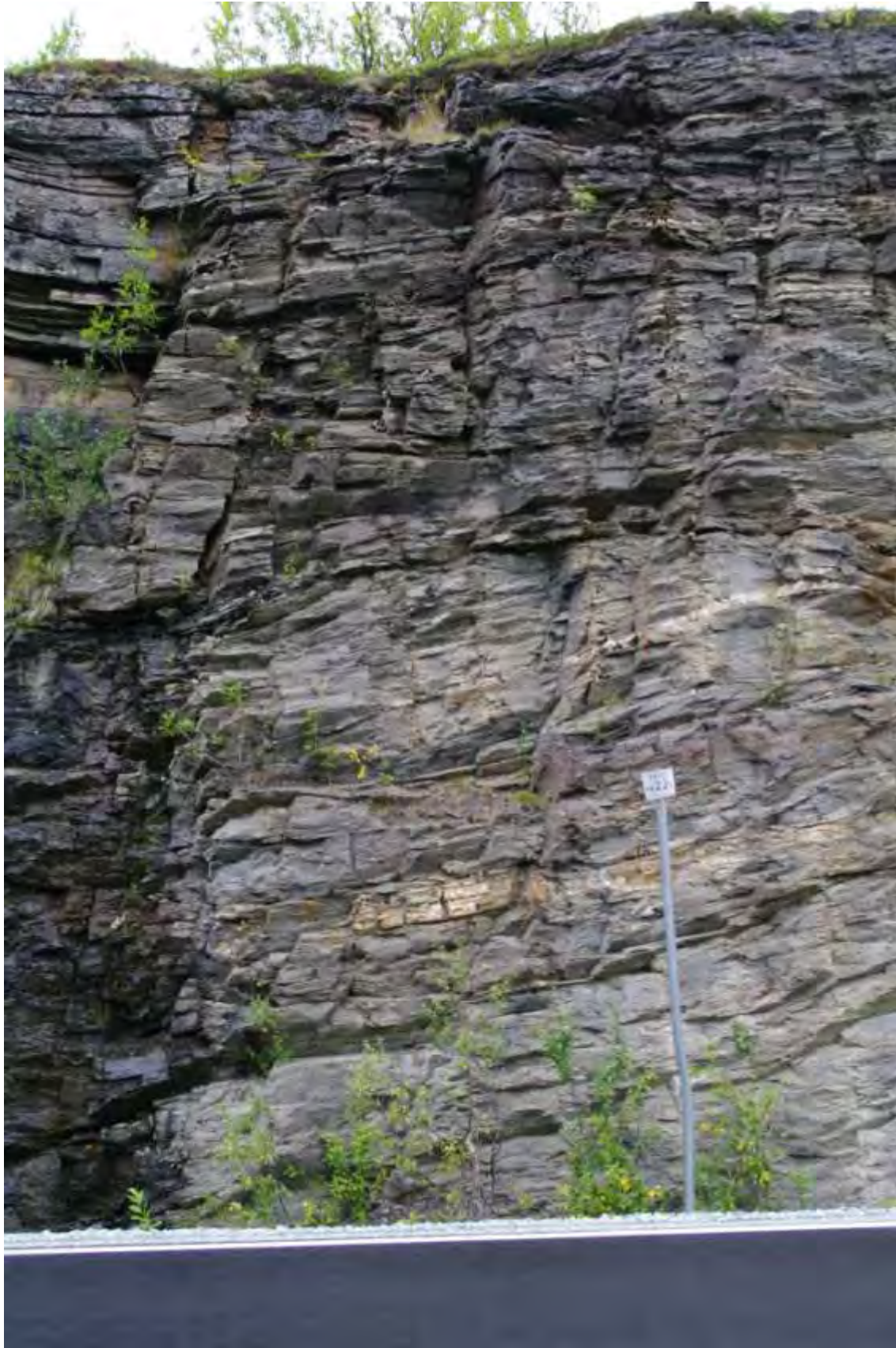
Bilde 26 Nært vertikalt sprekkesett, sprekkesett med 50° fall og horisontal foliasjon gjør fjellet småfallent p.4040.
