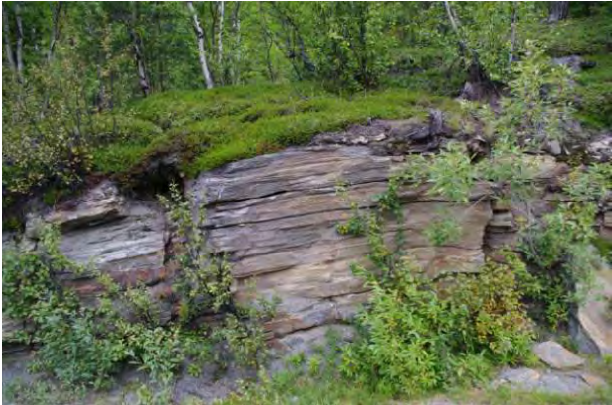
Bilde 11 Åpne vertikale sprekker i dagfjellsonen ved p. 2035 (GPS 310).
