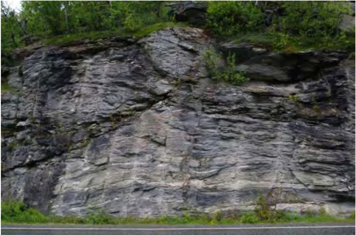
Bilde 15 Horisontalt foliert fjell med gjennomgående utvasket sleppe med sprekkeåpning ca 1dm. P. 2490 (GPS 318).
