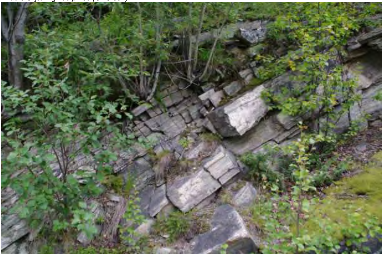
Bilde 4 Småfallent fjell til følge sprekkesett 30^{\circ}N/50^{\circ}Ø
