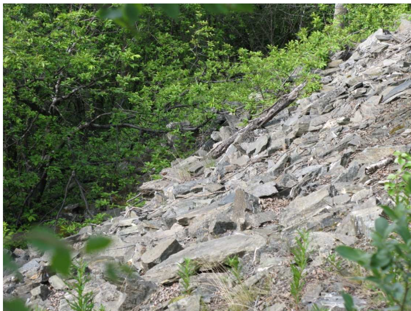
Figur 4 Blokksteinsfylling med lite finstoff bruker svært lang tid på gjengroing
