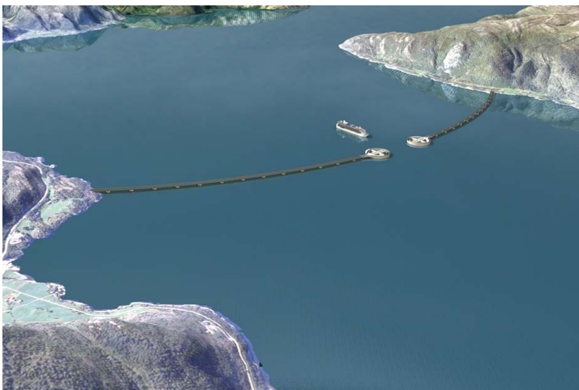
Figur 4: Oversikt flytebrualternativ med skipspassasje midtfjords
