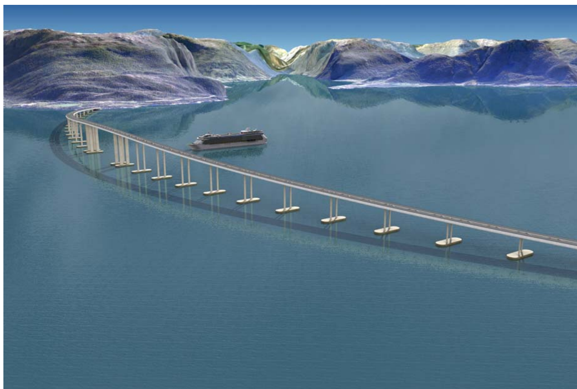
Figur 1: Oversikt flytebru med høybru midtfjords
