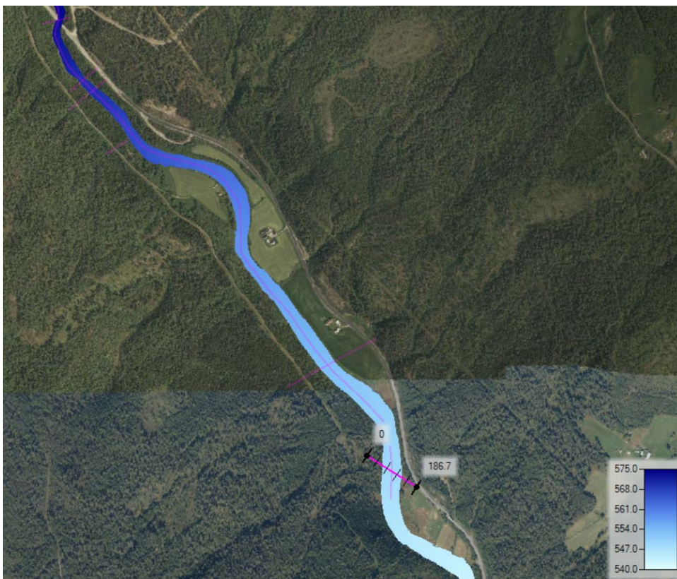
Figur 4 Vannflaten i høyde over havet for en 200 års flom langs Tunna.
