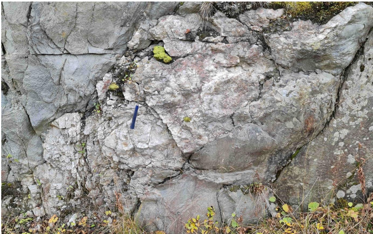
Figur 19: Stor, uregelmessig, grovkrySTALLinsk, litt misfarget kvartsutfelling i kvartsitt, ca. profilmeter 3100
