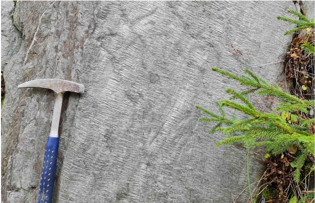
Figur 12: Mikrofoldet, tynt lag av glimmere/kloritter i kvartsitt, ca. profilmeter 3050. Sånne lag kan være rustfarget i flekker som viser forvitring av disse mineraler
