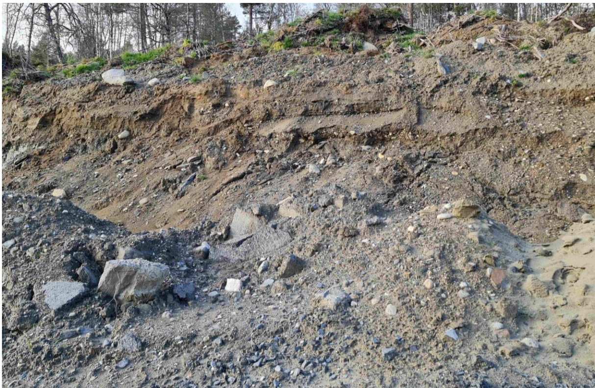
Figur 4: Tunnas grusig sand elvesediment, ved inngangen til anlegget, ca. 600 moh
