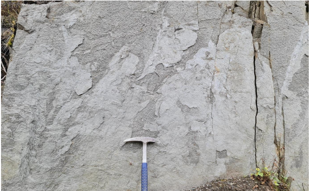
Figur 14: Tynt, mykt revnende glimmerlag med lag av sand bak det, i kvartsitt, ca. ved profilmeter 3050
