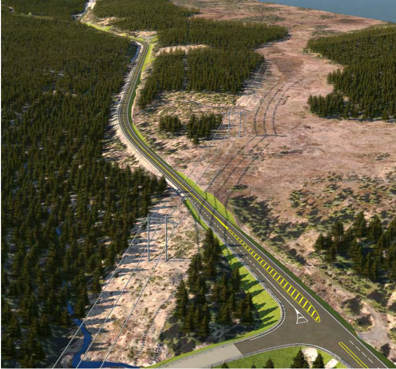
Figur 35: Vegmodell for utbedring av strekningen fra avkjørsel til Lygna skisenter og videre nordover.
