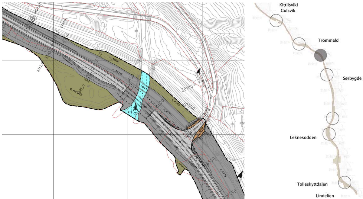
Figur 8-12: Til venstre: Ny veg med bredere kurvatur legges på utsiden av eksisterende veg, og det etableres både ny avkjøringsveg og ny bru som følge av dette. Til høyre: Angivelse av hvor i planområdet strekningen befinner seg.
