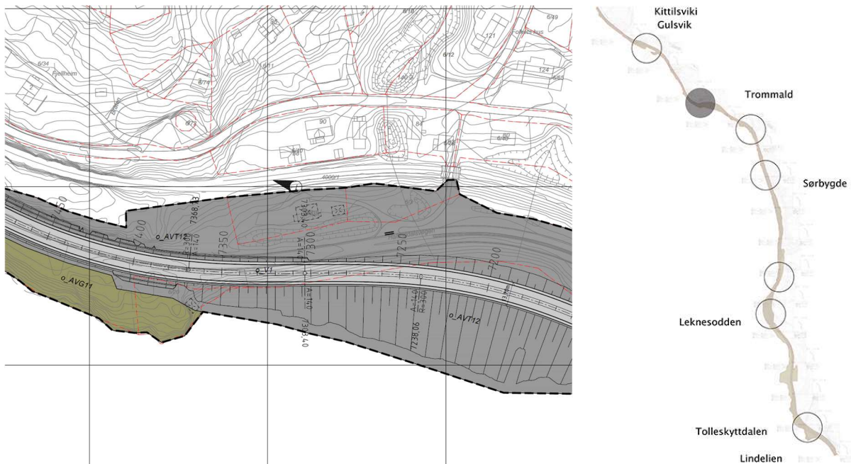
Figur 8-13: Til venstre: Kjørefelt med midtrekkverk mellom kjøreretningene. Til høyre: Angivelse av hvor i planområdet strekningen befinner seg.
