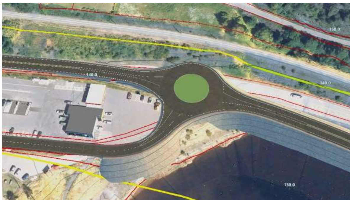
Figur 6-3 Forslag til utforming av rundkjøring (EFLA/Stener Sørensen)
