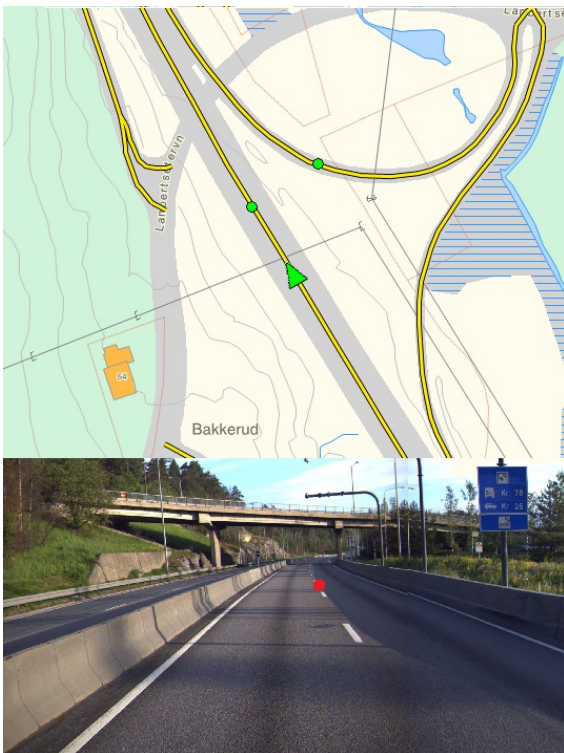
Eksempel på veg med to automatiske bomstasjoner. Rødt punkt viser anbefalt punkt for registrering geometri på hovedveggen (E6) bomstasjon.
