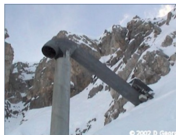
Figur 4: Skredutløsning med GazEx
