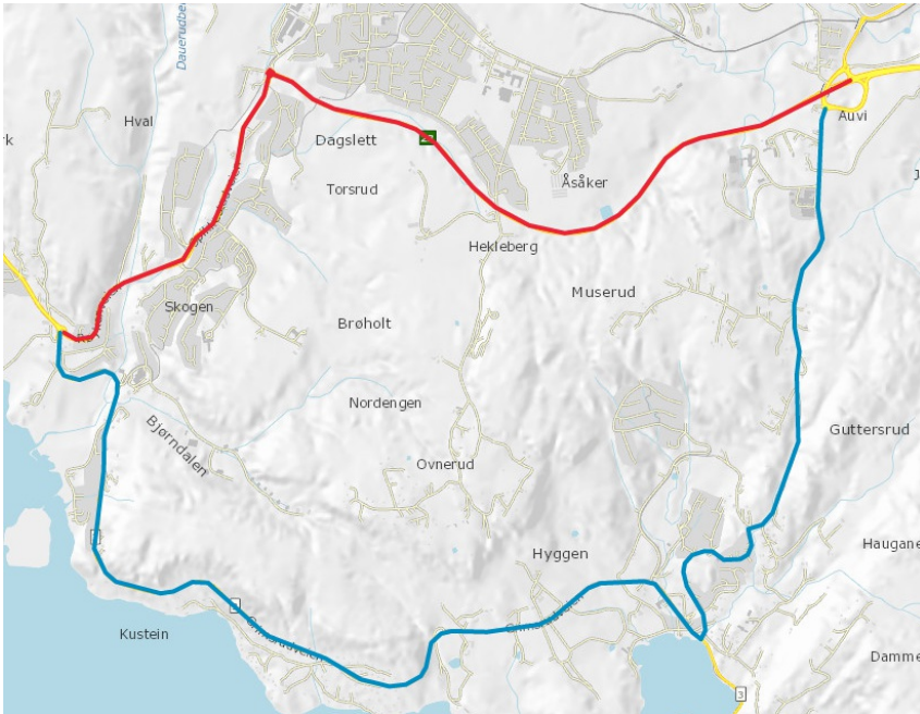
Figur 8: Merk at omkjøringsruten ikke er ført helt fram til endepunktet for stengningslenke i østre ende (ved Auvi), men starter nedstrøms av alle forgreininger og rampesystem inn mot hovedvegen.
