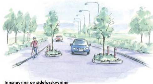
Innsnevring og sideforskyvning
