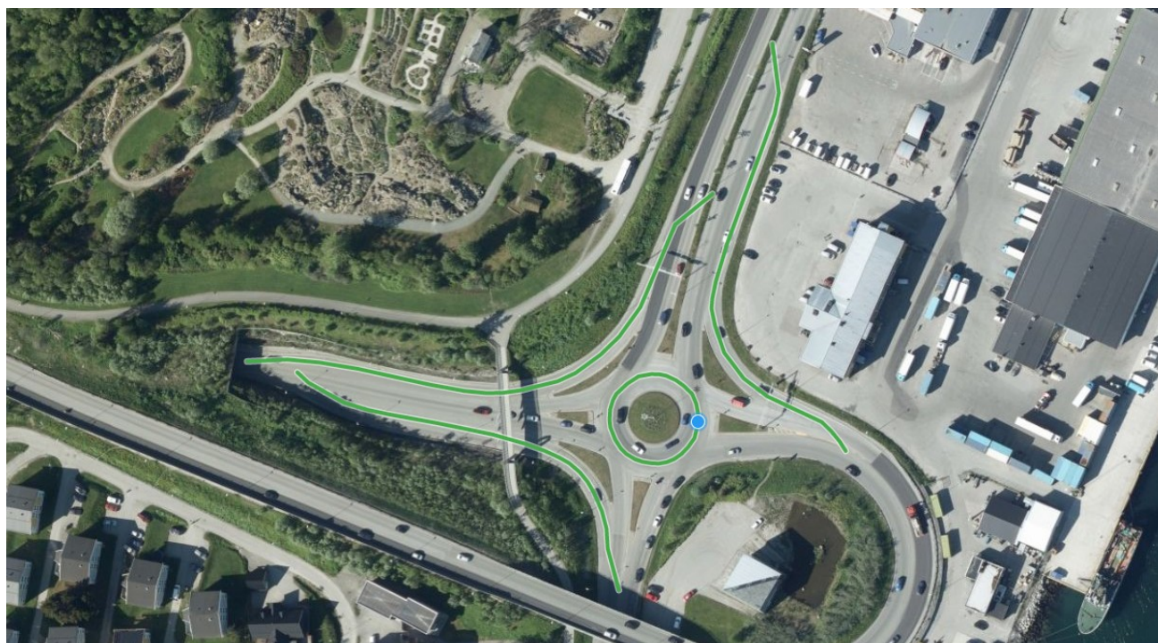
Figur 1 Kryssystemet (blått punkt) for E8 i Tromsø består av flere kryssdeler (grønne strekninger). Dette er både selve rundkjøringen og de tre avkjøringsfeltene. (Foto: Fra Vegkart)
