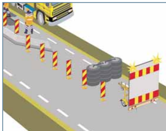
Figur 4.14: Tversgående sikring på kjørebane, med varslingsutstyr.
