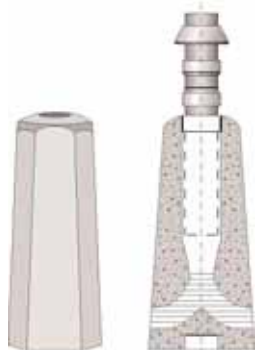
Betongfundament med låsering med kabelinntak
